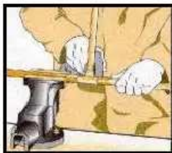
Limpiar con un trapo el sobrante de decapante
