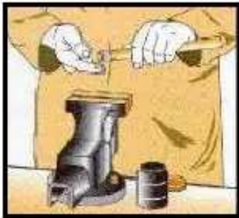
Aplicar decapante en el exterior del tubo, y en el interior de los accesorios.
