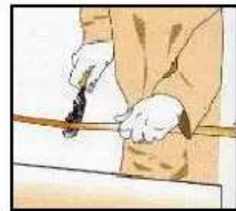
Corte de un tubo con cortatubos.
