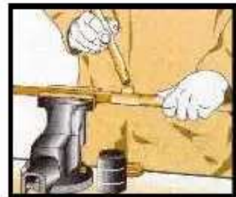
Montar los tubos en sus accesorios encajandolos hasta hacer tope.
