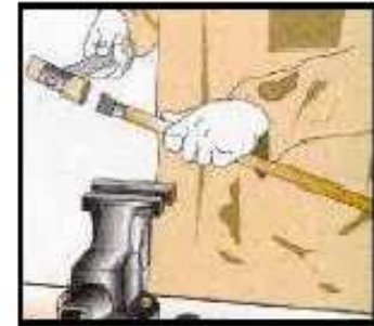
Para corregir las posibles deformaciones producidas por el corte es conveniente introducir un cilindro calibrado de la medida necesaria
