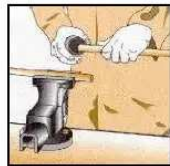
Eliminación de las rebabas producidas al cortar el tubo, en el interior y exterior del mismo, para evitar cualquier obstrucción.
